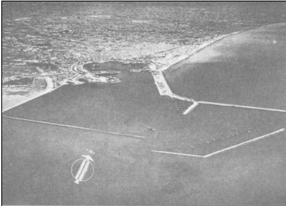
Imagen 11: Vista aérea del puerto de Valencia en 1934, con la escollera norte, hoy casi extinta, construida con la cantera del Puig en la Sierra Calderona. (Fuente: web Historia de la Aeronáutica http://www.histaer.org , autor Julián Oller).
