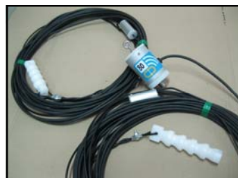
Caja Iler40 y antena dipolo doble http://cucoteam.blogspot.com.es/
