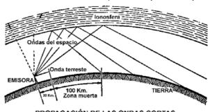
PROPAGACIÓN DE LAS ONDAS CORTAS
